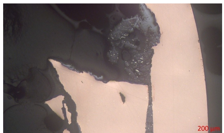
Lötstelle mit Grat, Erosion des Grundwerkstoffes am Bogen
