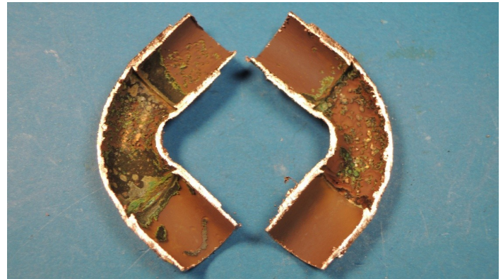
Winkel mit Wandungsdurchbruch an einem Grat Bildquelle: MHW
